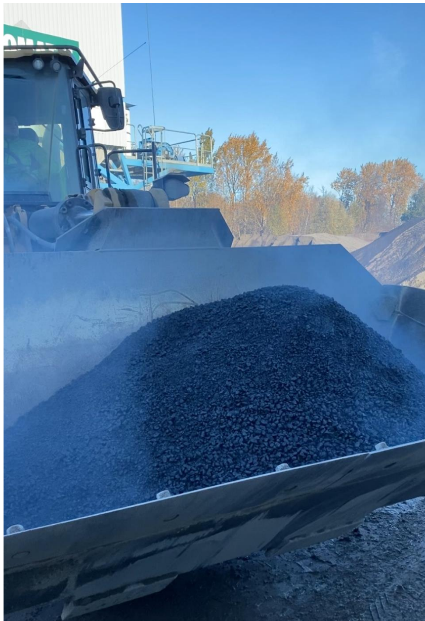
Joonis 18. Liiga kõrge segamistemperatuuri tulemusena ebaõnnestunud asfaltsegu. Pildil on visuaalselt näha suitsemist, mis on tingitud ligniini söestumisest.
