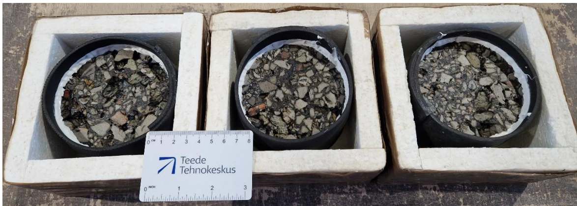
Joonis 11. AC 16 surf ligniiniga (T1) proovikehad pärast katset
