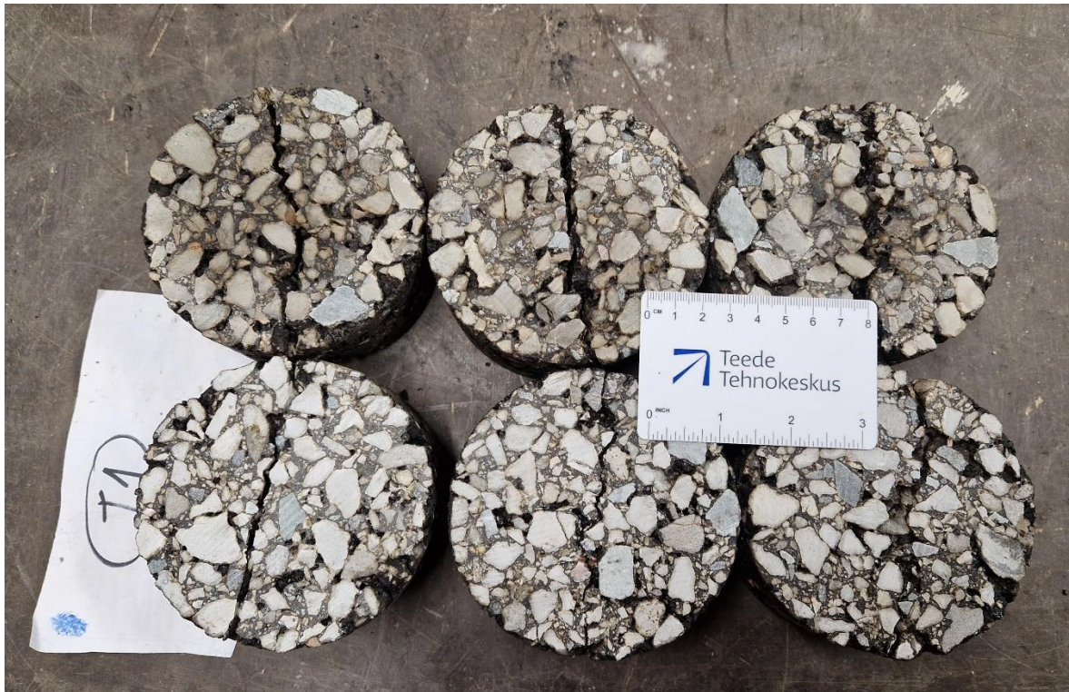
Joonis 16. AC 16 base ligniiniga (T1) proovikehad pärast katset
