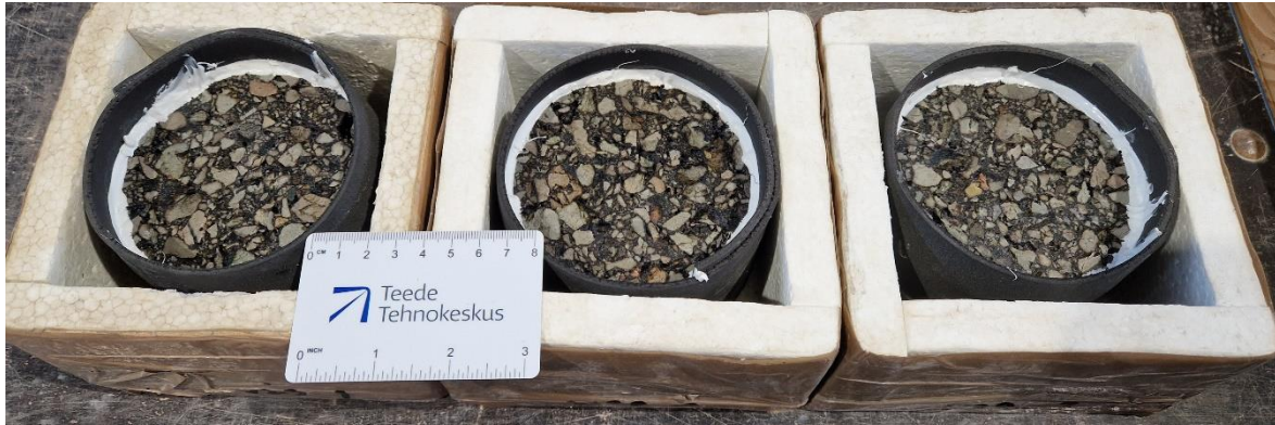
Joonis 10. AC 16 base referentssegu (V23) proovikehad pärast katset
