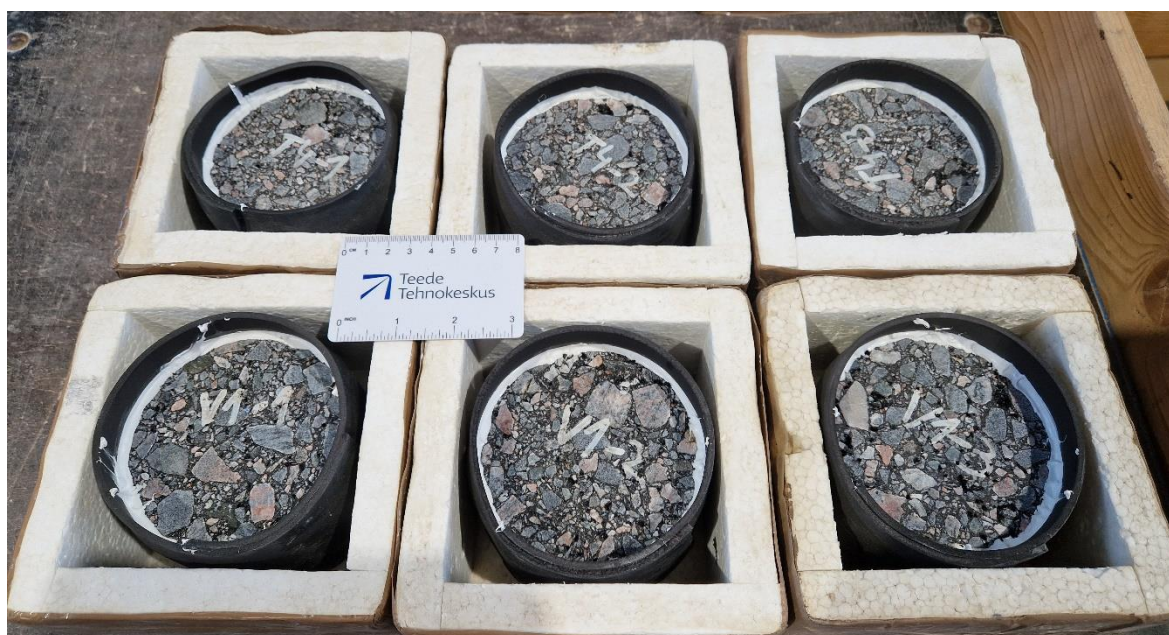
Joonis 9. AC 16 surf segude (V1 & T4) proovikehad pärast katset
