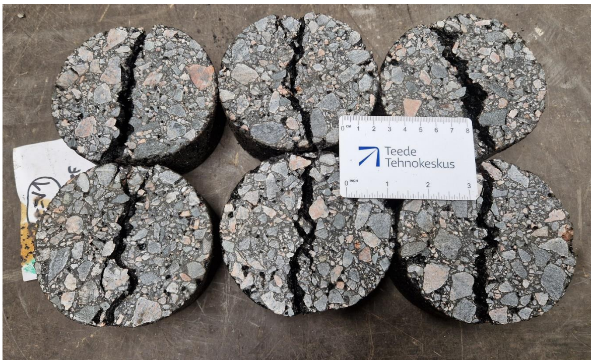
Joonis 13. AC 16 surf referentsegu (V1) proovikehad pärast katset
