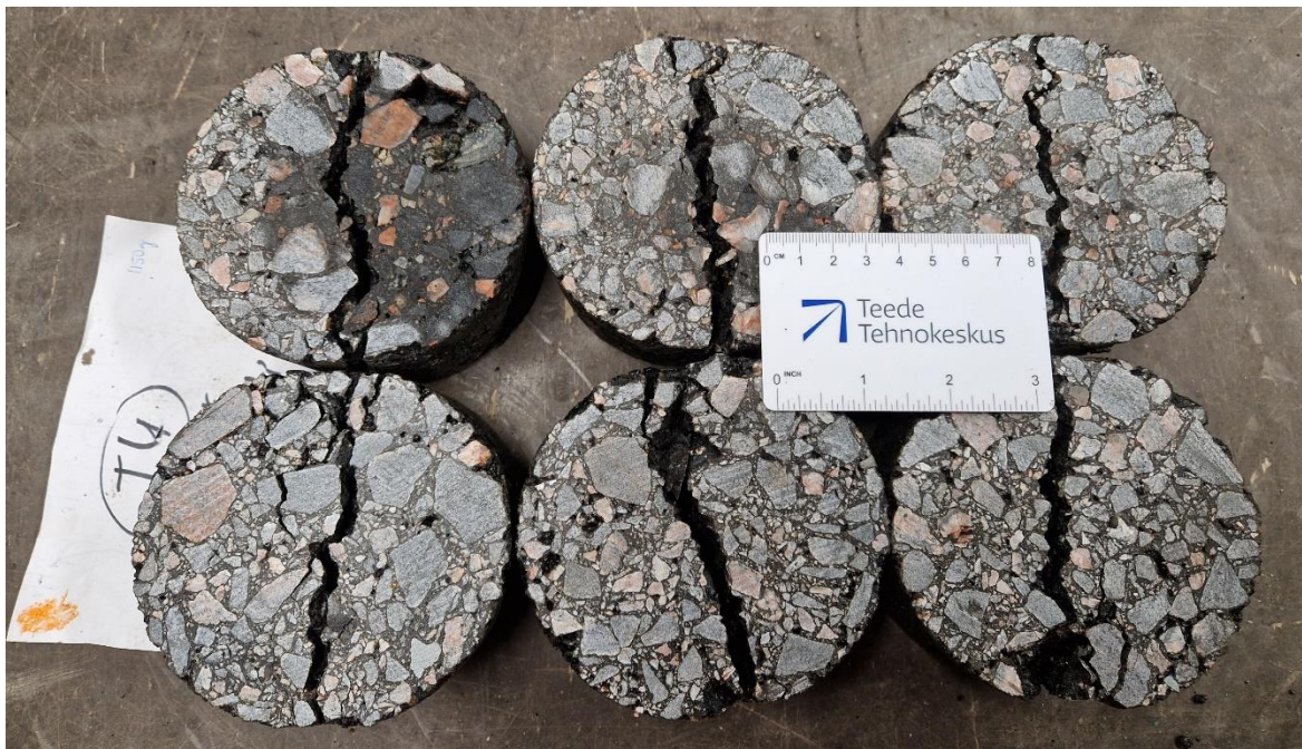
Joonis 14. AC 16 surf ligniiniga (T4) proovikehad pärast katset
