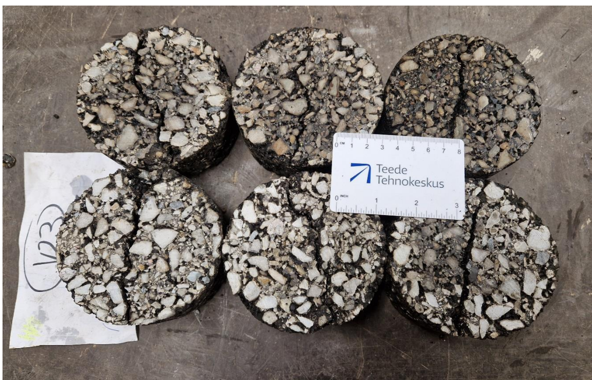
Joonis 15. AC 16 base referentssegu (V23) proovikehad pärast katset
