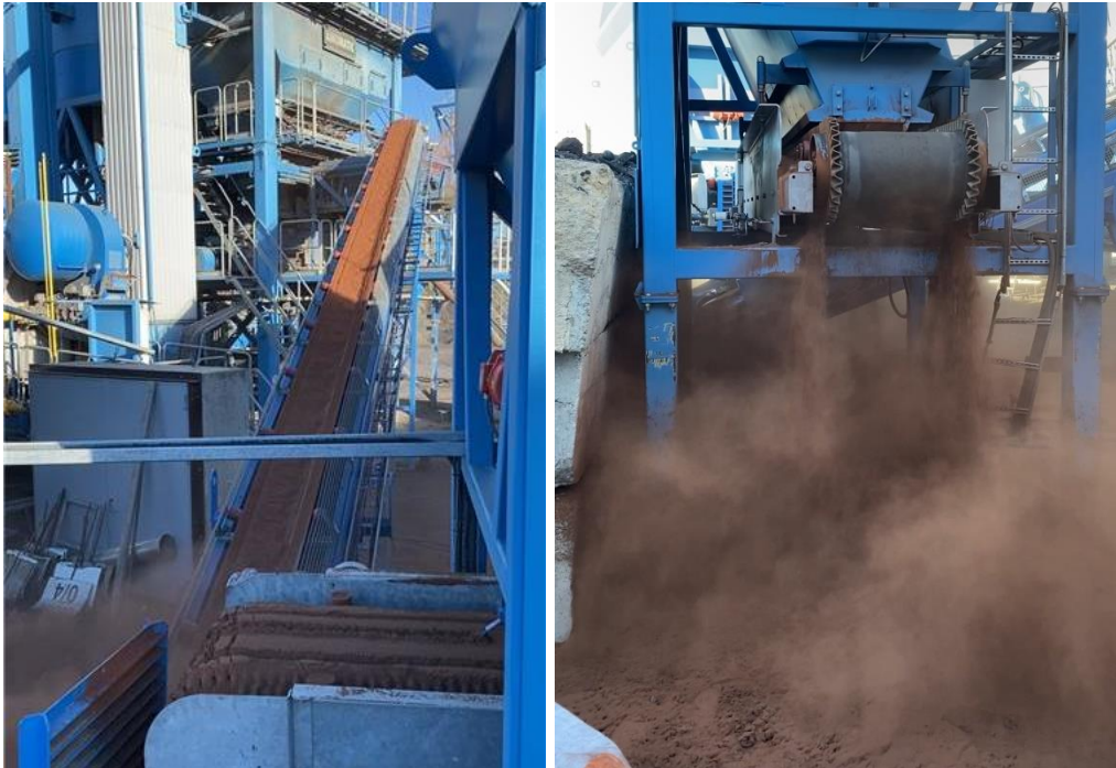
Joonis 17. Ligniini doseerimine freespuru doseerimisliiniga otse segistisse. Parempoolsel pildil on näha ligniini kadusid tootmises.
