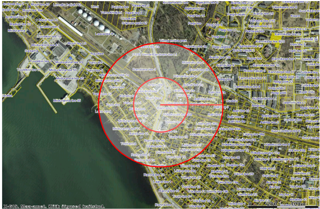
Joonis 1. Bensiini tsisternauto BLEVE ohualad ehitistele (191 m) ja inimelule (436 m). Allikas: xgis.maaamet.ee.
