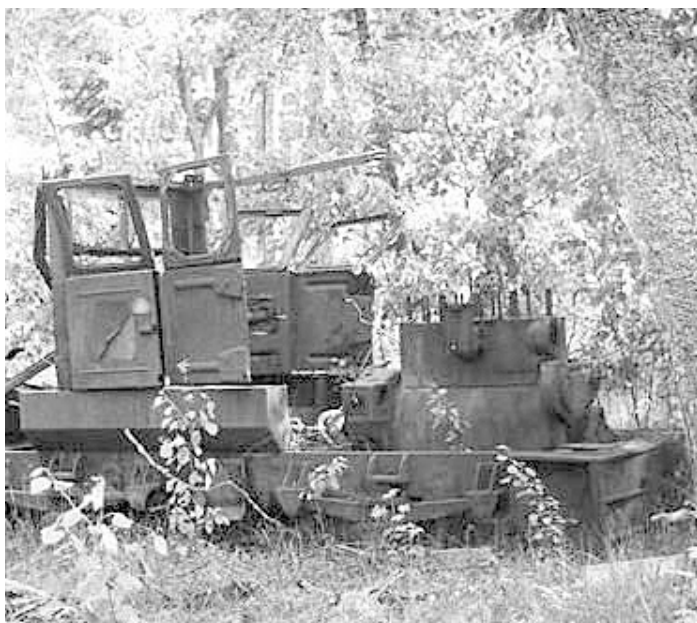
Naissaarel asuv kitsarööpmeline lokomootor, mis on ehitatud T-54 lintraktori baasil 1958. a. Selle Eestis ainsana säilinud eksemplari on suutnud kohalikud saareelanikud mitmeks jupiks lammutada.
